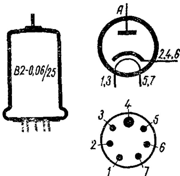
1 и 3 – подогреватель (нить накала); 2, 4, 6 – катод; 5 и 7 – подогреватель (нить накала); А – вывод на баллоне - анод
