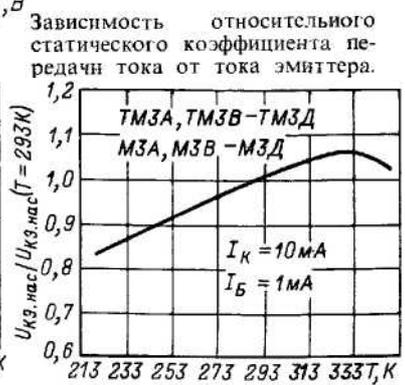
Зависимость относительного статического коэффициента передачи тока от температуры.
