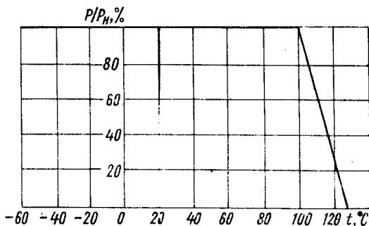
$P$  — допускаемая электрическая нагрузка, Вт;
