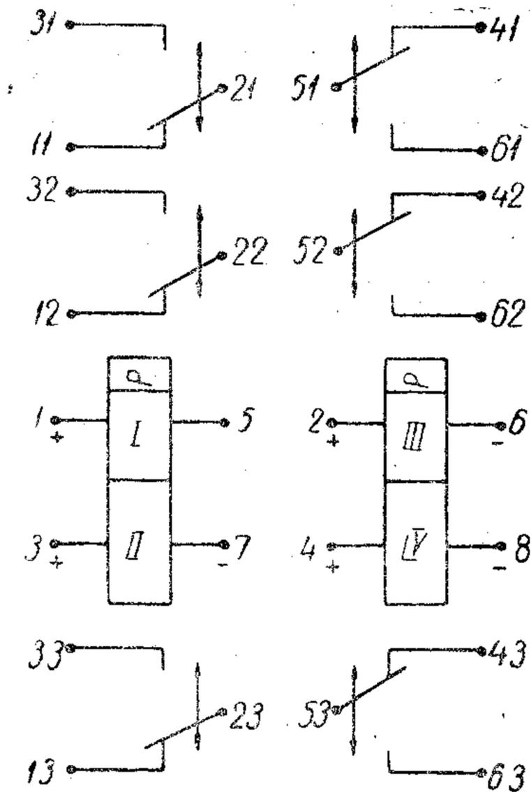
Схема изображена после подачи импульса постоянного тока на обмотки I и II.
