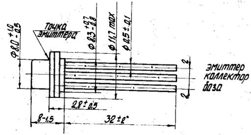
\* Допускается выпуск с длиной выводов  $40 \pm 2$  мм
