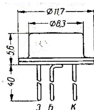
Кремниевые плоскостные транзисторы, проводимость р-п-р. Предназначены для усиления и генерирования электрических сигналов низкой частоты при повышенной температуре окружающей среды.
