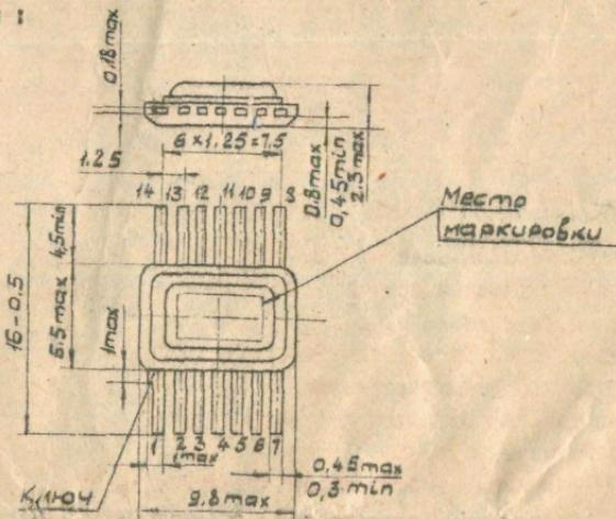
Предельные отклонения размеров между осями двух любых выводов  $\pm 0,1$  мм.
