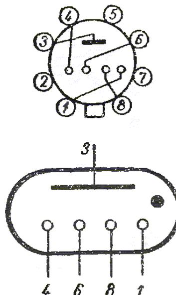
Выходы электродов: 1 - катод нулевой; 3 - анод; 4 - подкатод 1-й; 6 - подкатод 2-й; 8 - катод; 2, 5, 7 - не подключены.
