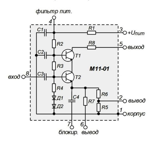
Для стабилизации рабочей точки по постоянному току, используется цепочка диодов Д1 и Д2, а также отрицательная обратная связь посредством R5, R6 и R7.
