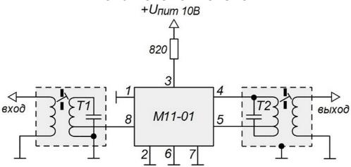
На первом рисунке показана типовая схема включения микросхемы как входного малошумящего усилителя. Для согласования импедансов по входу и выходу применяются резонансные контура Т1 и Т2.
