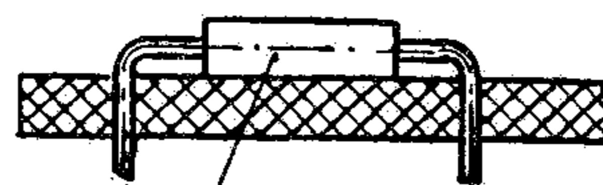
*Клеить после трехразового покрытия лаком З-4100 и СБ-1С с промежуточной сушкой каждого слоя в течение 10 мин при +60 - +70°C*
