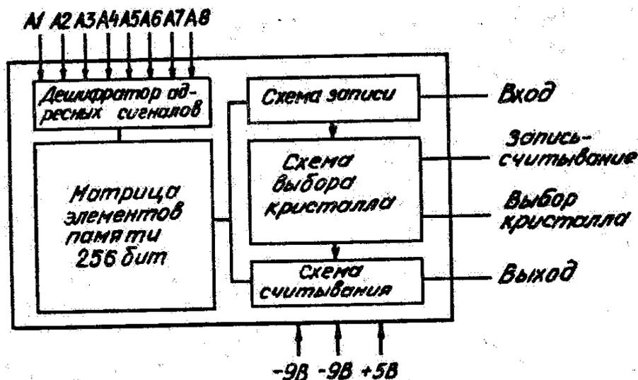
Назначение выводов: 1, 2 — входы адресные А5, А6; 3 — выход; 4, 5 — входы адресные А3, А4; 6 — вход адресный А1; 7 - напряжение питания управления ( $U_{П1}$ ); 8 — напряжение питания матрицы ( $U_{П2}$ ); 9 — вход адресный А2; 10 — свободный; 11 - вход; 12 — вход разрешения записи-считывания EWRRD; 13, 14 — входы адресные А7, А8; 15 — вход выбора кристалла CS; 16 — напряжение смещения подложки ( $U_{см}$ ).
