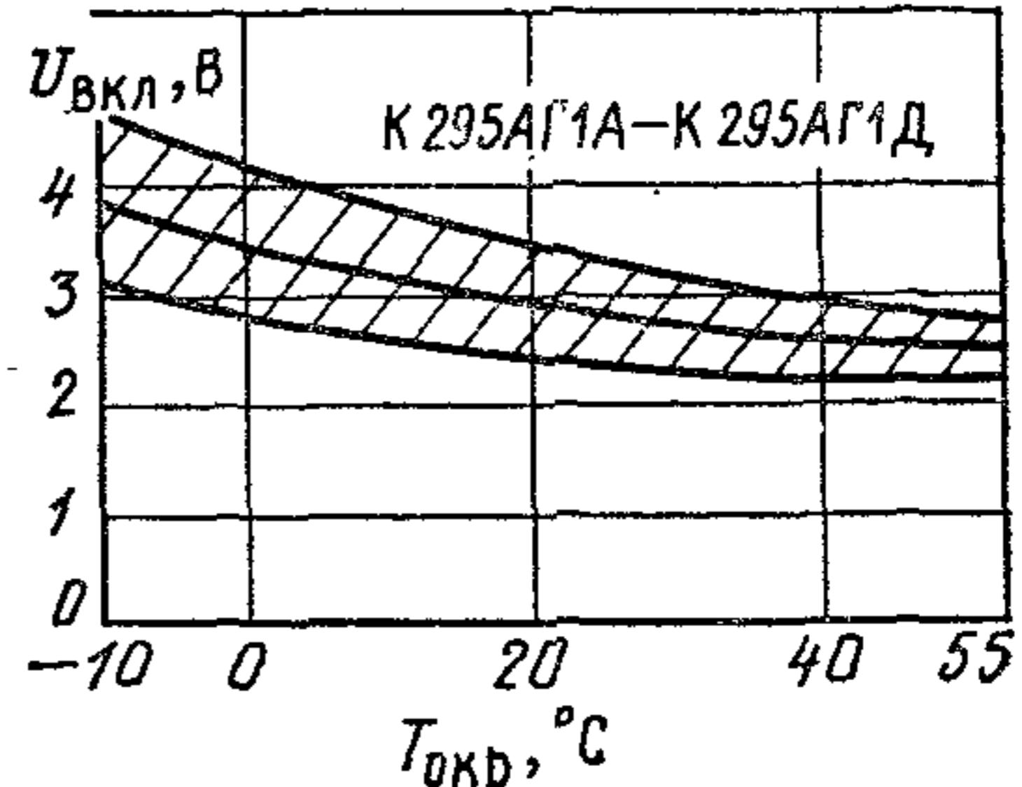
Зависимость напряжения включения от температуры окружающей среды (показаны зона разброса и усредненная кривая)
