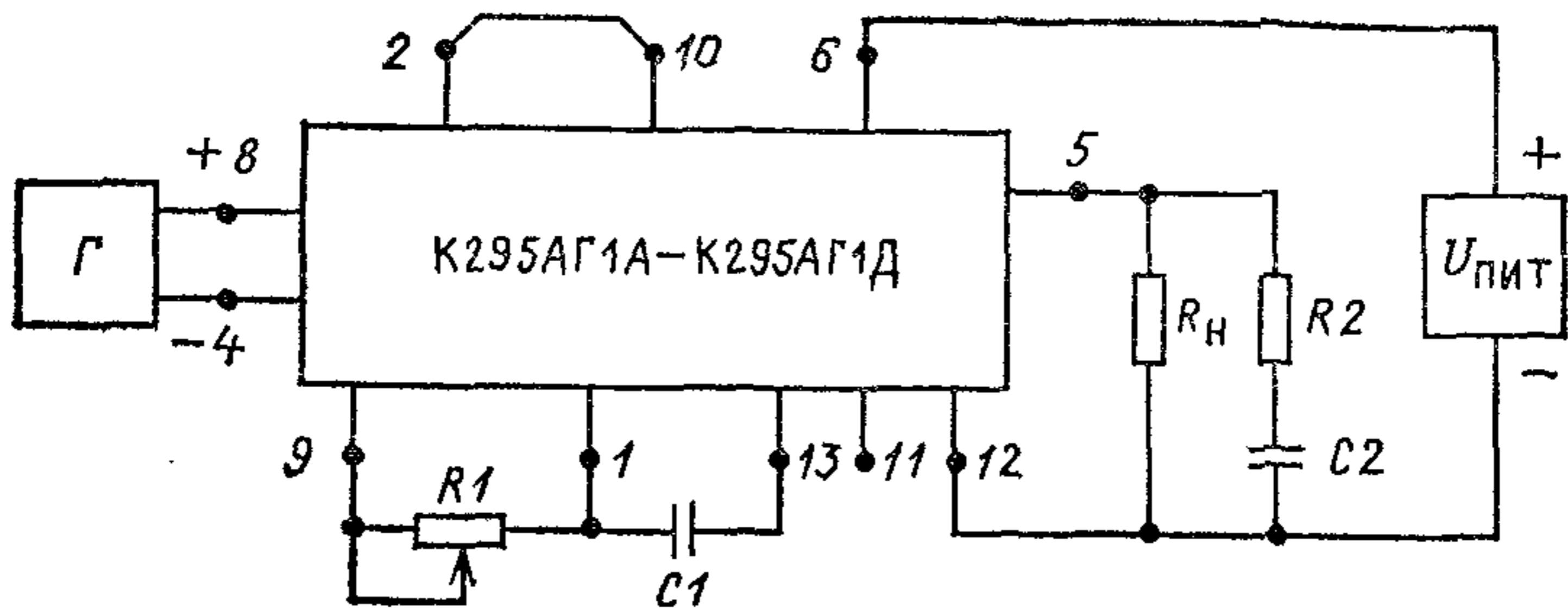
Схема включения оптоэлектронного одновибратора (сделанные на схеме соединения даны для  $U_{пит}=48$  В). При напряжении 27 В необходимо соединить выводы 11 и 12, при напряжении 12 В — выводы 11 и 13
