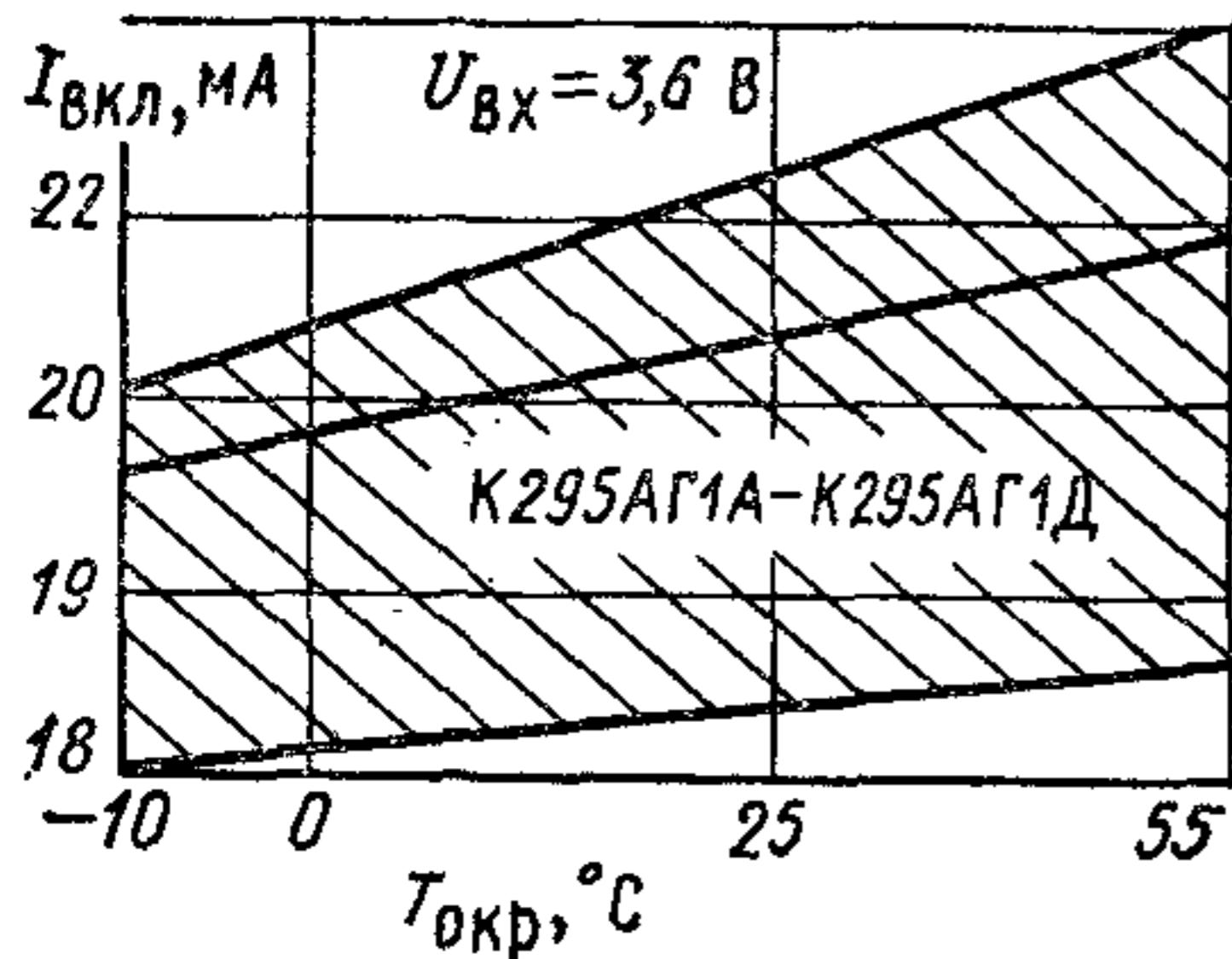
Зависимость тока включения от температуры окружающей среды (показаны зона разброса и усредненная кривая)
