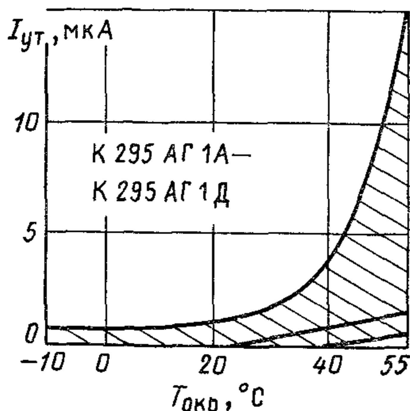
Зависимость тока утечки от температуры окружающей среды (показаны зона разброса и усредненная кривая)
