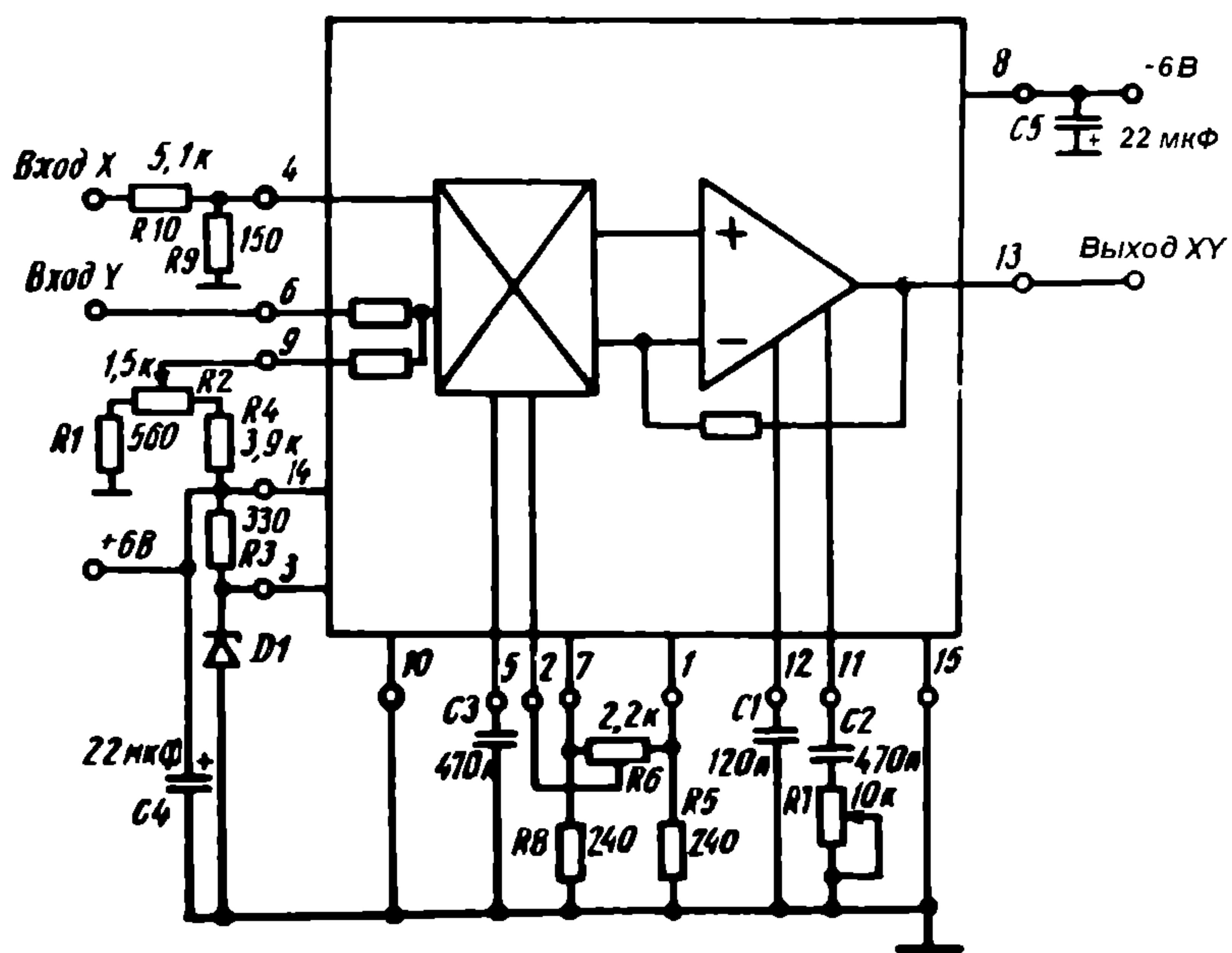
Схема включения микросборки К26ХА05
