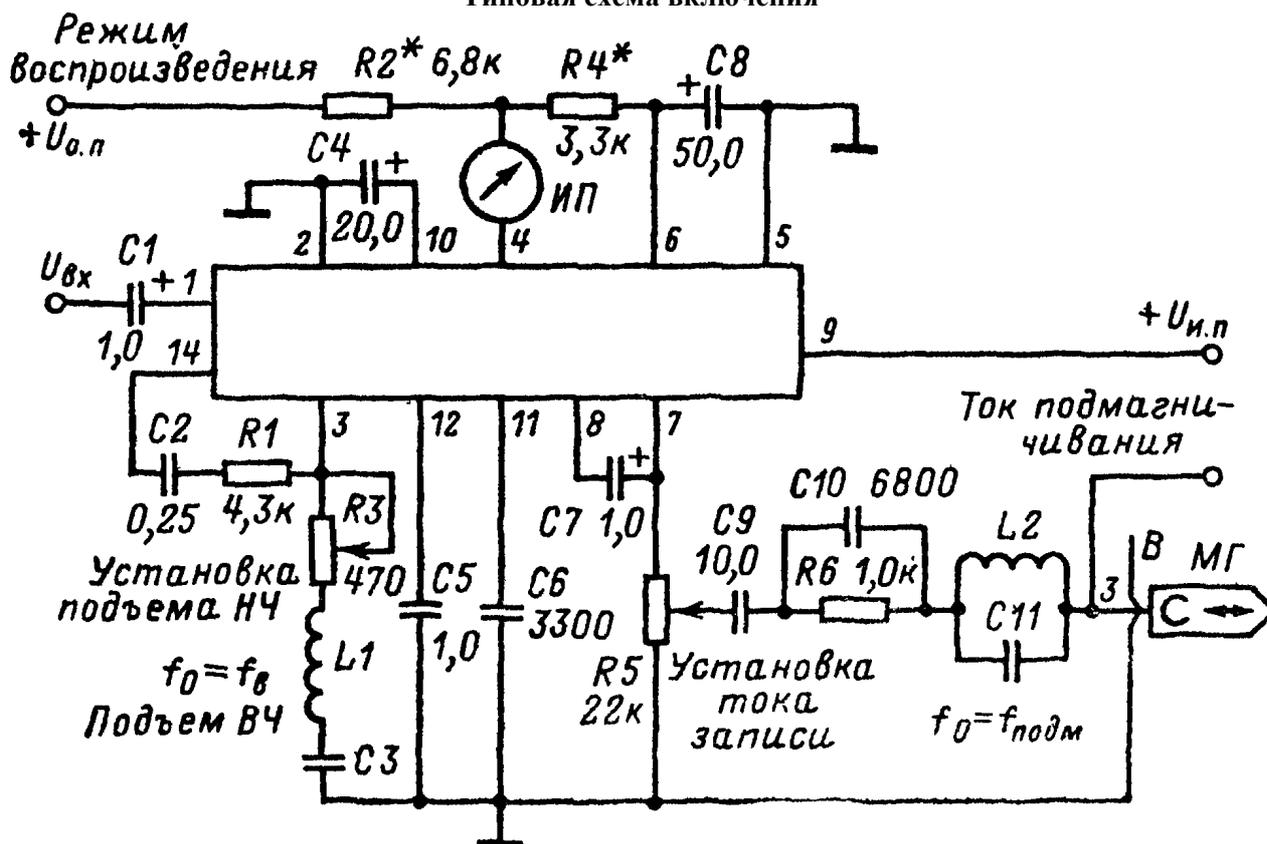
ИП - стрелочный индикатор типа М478/3; МГ - магнитная головка УГ-9 ( $L = 12 \text{ мГ} \pm 20\%$ ;  $R = 50 \text{ Ом} \pm 15\%$ ,  $Q = 2,2 \pm 10\%$ );  $I_z < 0,3 \text{ мА}$  (оптимальный).
