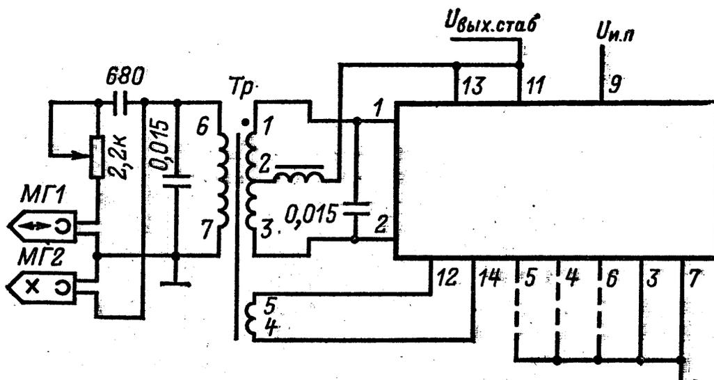
$MG_1$  — магнитная головка УГ-9 ( $L = 12$  мГ);  $MG_2$  — магнитная головка СГ-9 ( $L = 0,3$  мГ).
