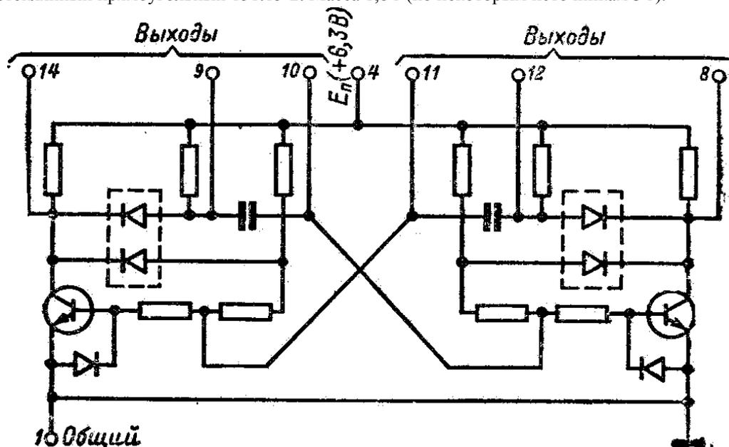
Элементная база – транзисторы 2Т318А, диоды 2Д901Б-1, диодные матрицы 2Д910А.
