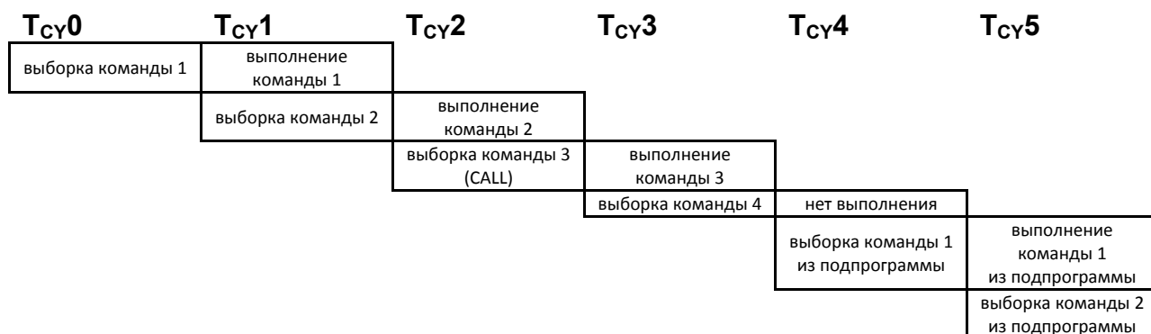
Рис. 4 Конвейерное выполнение команд
