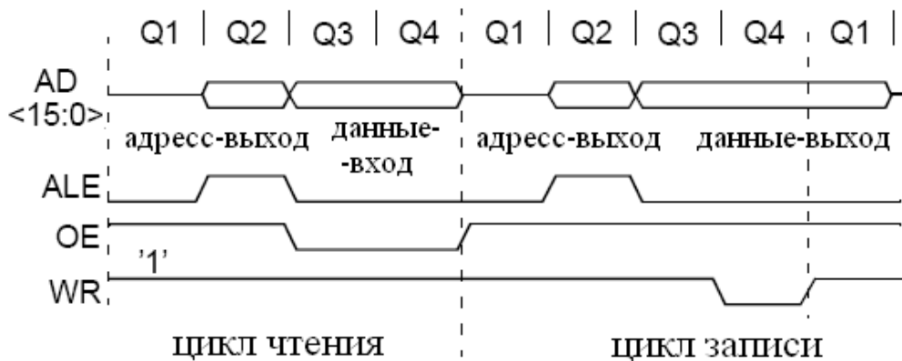
Рис. 14 Диаграммы сигналов доступа к внешней памяти программ
