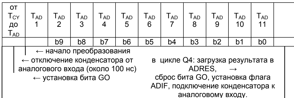
Рис. 80 Работа модуля АЦП по тактам
