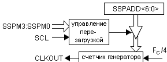
Рис. 56 Структурная схема генератора скорости обмена
