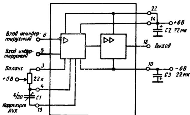
Схема включения микросборки К04УД02I
