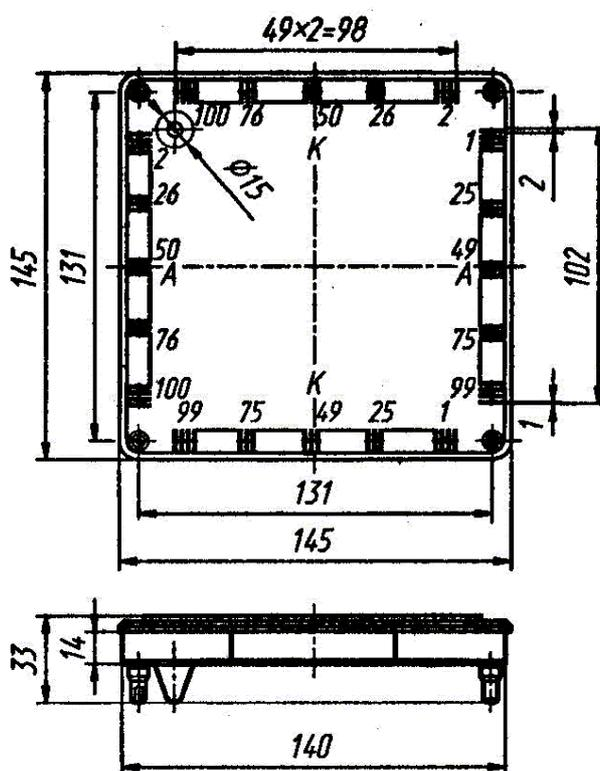
Предназначены для отображения сложной знакографической информации в информационных табло. Индикатор содержит две ортогональные системы электродов (анодов и катодов), в перекрестиях которых находятся индикаторные ячейки.
