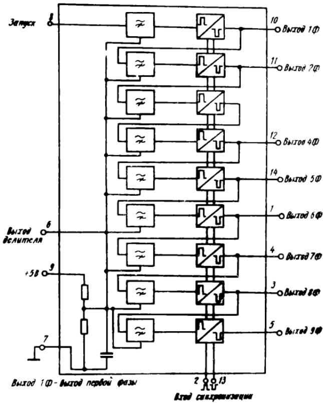
Пример записи в конструкторской документации : микросборка 25АП0 ТЭ3.480.ИЗ1.
