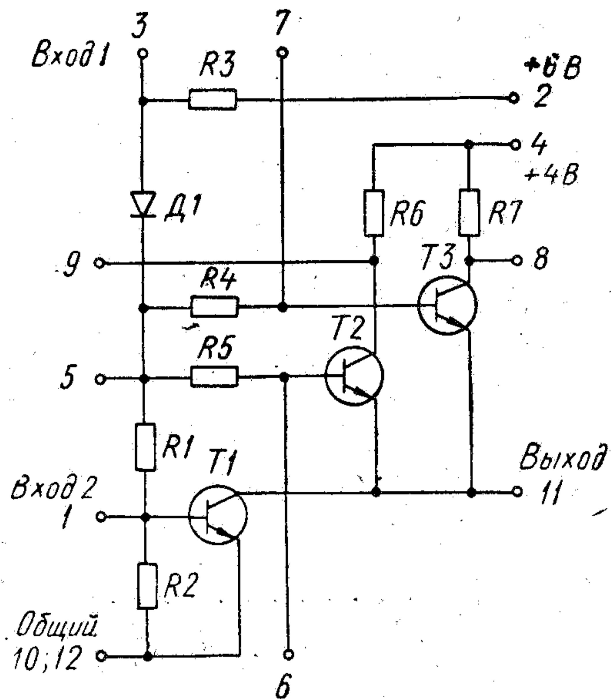
Микросхема применяется только со схемой управления, имеющей  $U_h$  не более 0,3 В.
