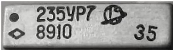
**Назначение:** усилитель промежуточной частоты с АРУ
