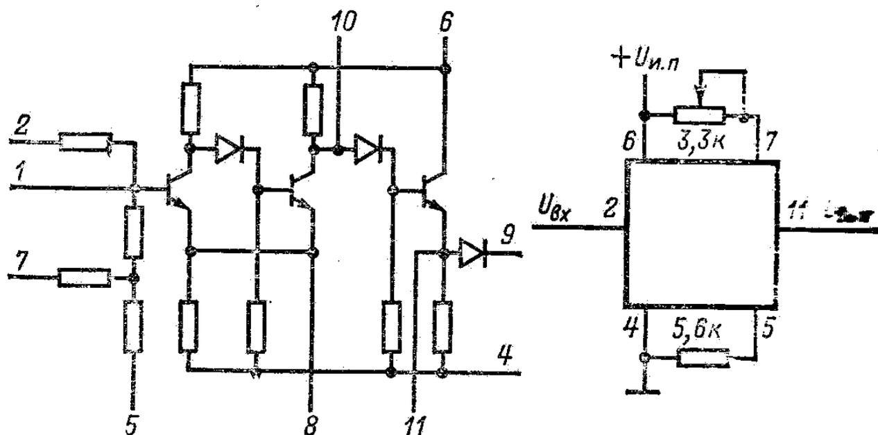
Изменением сопротивления резистора, включаемого между выводами 5 и 9, можно регулировать порог срабатывания. Резисторы, включаемые между выводами 7 и 6, 4 и 5, служат для изменения скважности выходных импульсов.
